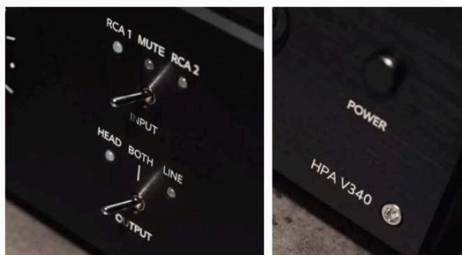
Mit Kippschaltern wählt man zwischen den beiden Eingängen und schaltet stumm (oben) und wählt aus, ob das Signal an den Line- oder Kopfhörer-Ausgängen anliegt oder an beiden.
